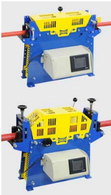
Kabel-Längenmessmaschinen mit elektronischem Zähler mit Speicherung der Messdaten. Für den Einsatz auf Kabelspulmaschinen mit Stromversorgung oder mit Netzteil für den Einsatz als Stand-alone-Lösung. Sehr robuste Konstruktion. Durch großen Messradumfang von 1 m hohe Messgenauigkeit von  $\pm 0,5 \%$ , Genauigkeitsklasse III, bei Temperaturen von 5-40 °C.
