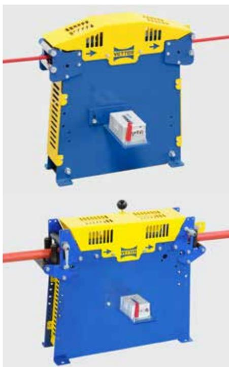
Kabel-Längenmessmaschinen mit mechanischem Zähler ohne Speicherung der Messdaten für den Einsatz als Stand-alone-Lösung. Sehr robuste Konstruktion. Höchste Messgenauigkeit durch großen Messradumfang von 1 m, Ziffernhöhe 7 mm. Hohe Messgenauigkeit von  $\pm 0,5 \%$ . Fordern Sie bitte unser ausführliches Angebot an.
